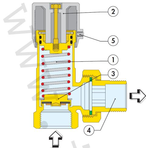
Síla kompresní pružiny (1) se nastaví pomocí ovládací hlavy (2), přičemž nastavená síla kompresní pružiny působí na uzavírací clonu (3), která se změnou hodnoty tlaku otevře a umožní průtok obvodem. To vše za předpokladu je-li clona vystavena dostatečnému rozdílovému tlaku vyvýjeného kompresní pružinou a tlaku vyvýjeného na uzavírací clonu. Tento stav následně umožňuje průtok vody výstupem (4), čímž se omezuje tlakový rozdíl mezi dvěma body v systému, kde je ventil namontován.
