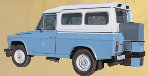
Gaz s generátorem DOKOGEN r. 1986
