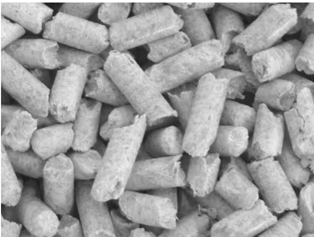
Obr. 17 - kvalitní dřevěné pelety - bílé bez černých teček (kūry)
