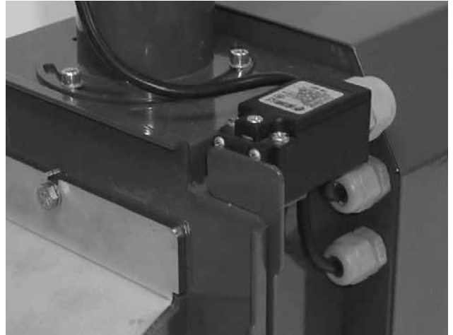
Obr. 8 - koncový spínač se speciálním dorazem
