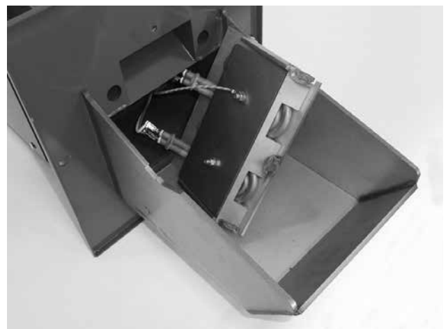
Obr. 4 - demontovaná deska se 2 zapalovacími spirálami
