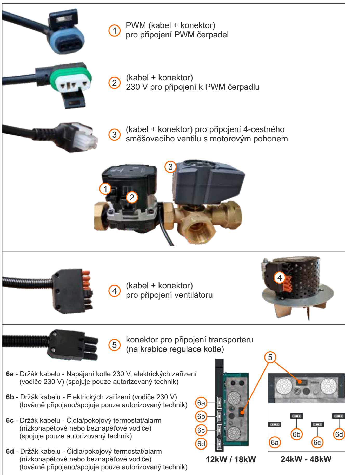
Obrázek 5. Konektory / kabely s konektory, které je nutné připojit při montáži kotle.
